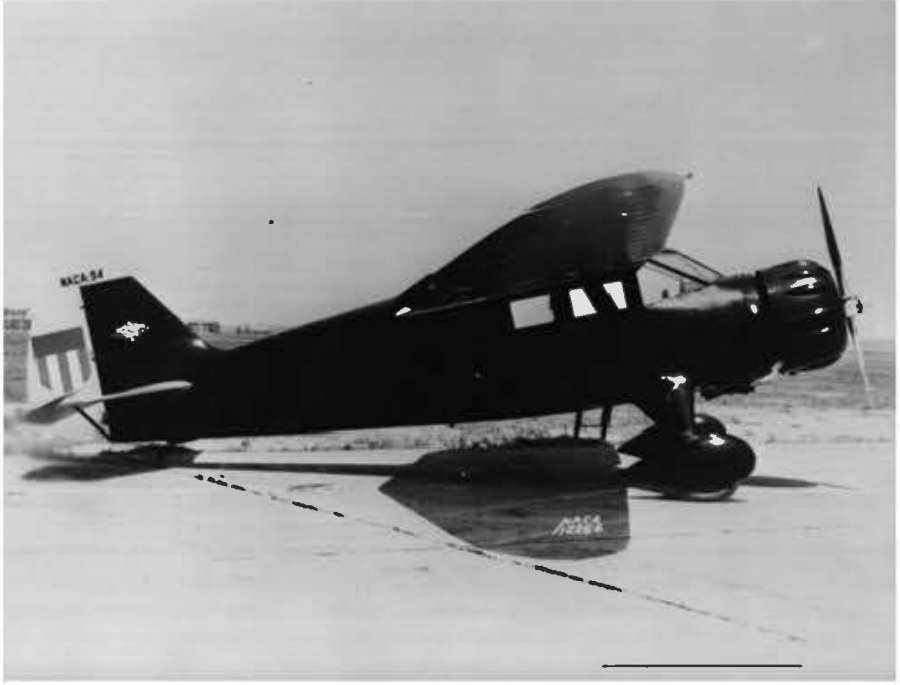
الشكل 3-4 الطائرة ستينسون SR-8A التي استخدمها هارتلي سوليه في قياسات اختبار الطيران الرائدة للاستقرار والتحكم (من تقرير NACA رقم 700، 1940).
