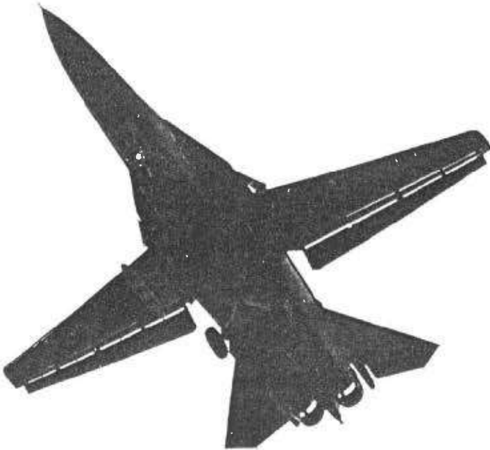
الشكل 16 - 1 تراجع الأجنحة بالكامل للطائرة F-111 عند زاوية 72.5 درجة وعدم تراجع كامل عند 16 درجة (صور سلاح الجو الأمريكي).
