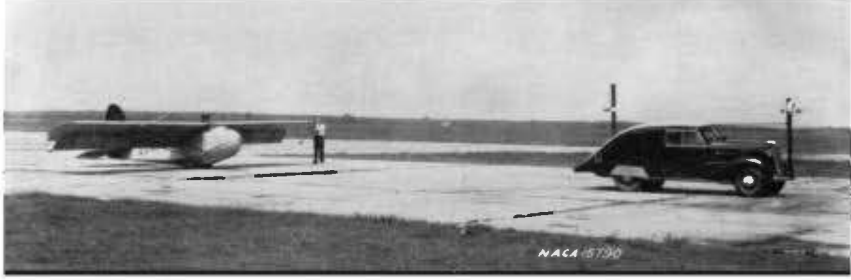
الطائرة الشراعية فرانكلين PS-2, يتم جرّها بسيارة لاختبارات التأثير الأرضي
