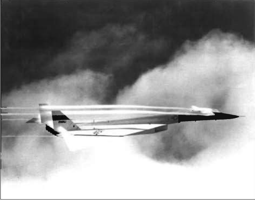
الشكل 11 - 15 الطائرة شمال أمريكا XB-70 أثناء الطيران. تنحرف أطراف الجناح إلى أسفل لزيادة الاستقرار الاتجاهي في السرعات فوق الصوتية (من : Bilstein, Orders of Magnitude , 1989).
