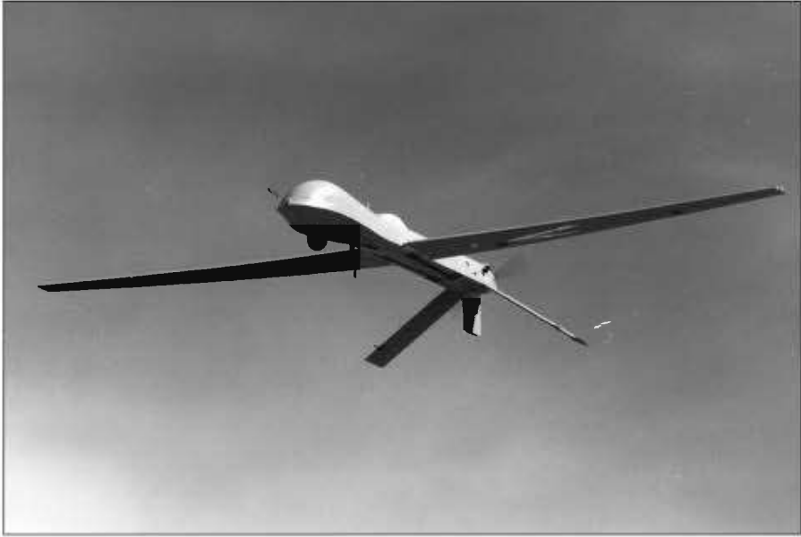
الشكل 14 - 11 طائرة بذنب V مقلوب، هي أمبر (Amber)، سلف الطائرة المسيرة (UAV) جينيرال أتوميك غنات (General Atomic Gnat-750)، التي استخدمت عام 1994 بمهمة استطلاعية فوق البوسنا (من شركة الأنظمة الرائدة Leading Systems, Inc).
